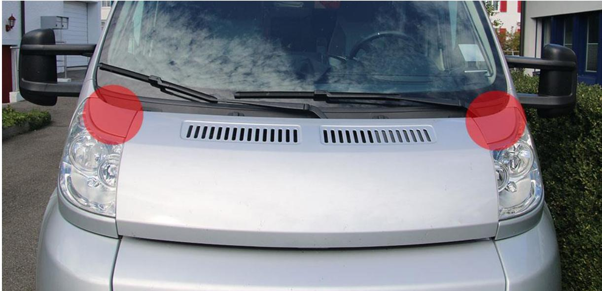
Dazu die Motorhaube öffnen, und je zwei Schrauben lösen
