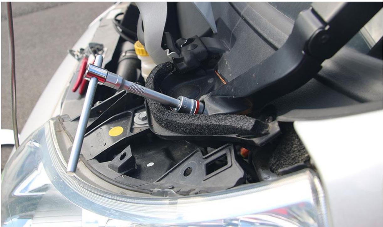
Nun müssen die Scheibenwischer demontiert werden. Die Schraube unter dem Scheibenwischer ist konisch gerippt.
