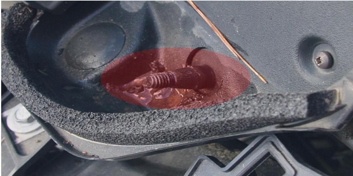
Darum muss der Scheibenwischer hochgehoben werden, etwas gerüttelt hilft, Kriechöl auch. Rütteln seitlich hilft nicht. Mit einem Schraubenzieher von unten Druck ausüben.
