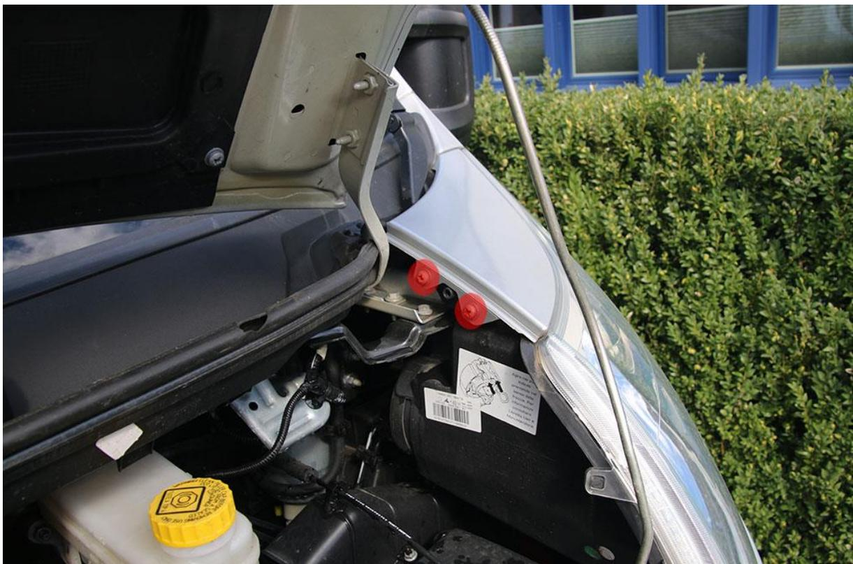
Wenn die Schrauben gelöst sind, mit der Hand tief unter die Abdeckung greifen und diese aus den Plastikverankerungen hochheben.
