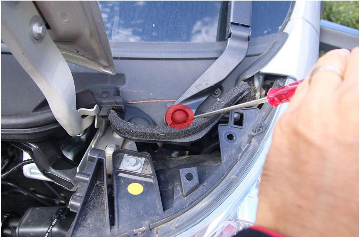
Die hervorkommende Mutter lösen. Bei mir sass die sehr fest und war auch schon etwas angerostet. Aber sie öffnete sich mit Kraftaufwand relativ schnell.
