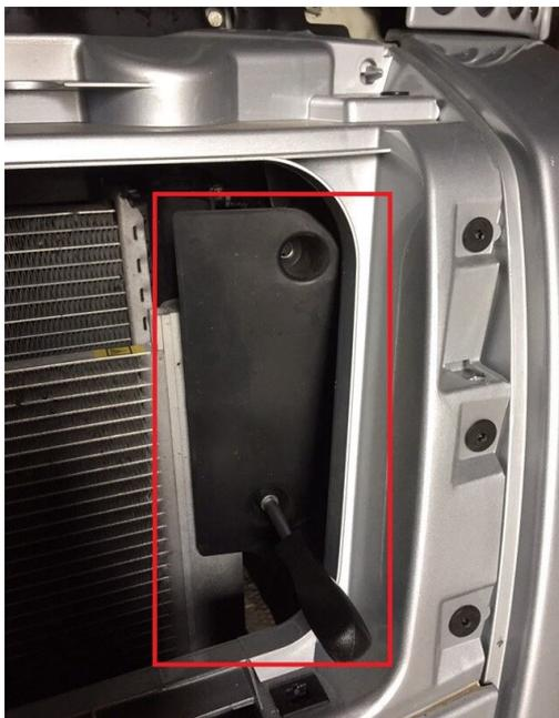
Die Klipse der Halteklammer mit Zuhilfenahme eines langen Schlitzschraubenziehers zusammendrücken und die Halteklammer entfernen.
