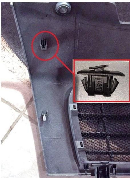
Die ausgebaute Kühlerverkleidung jetzt senkrecht in die unteren und oberen Haltenasen positionieren und einklipsen.
