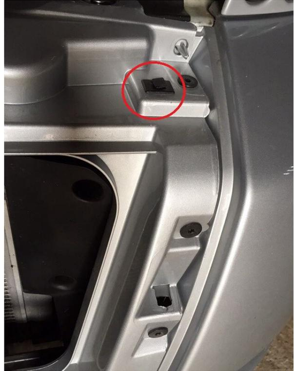
Auf der linken Seite (Draufsicht) von unten die Klipse der Halteklammer zusammendrücken und herausdrücken.
